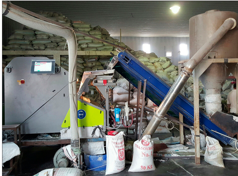
Bei PT. Rejeki Adigraha wird zur Kunststoffaufbereitung das Multi-Sortiersystem FLAKE PURIFIER von Sesotec (links im Bild) zur Separation von PVC eingesetzt.
